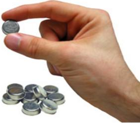
**Figure 6. IButton DS1922L temperature loggers.**
