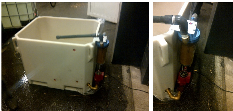
Mynd 11: Hringrásarkerfið sem úrbúið var hjá Matís fyrir tilraunina.
